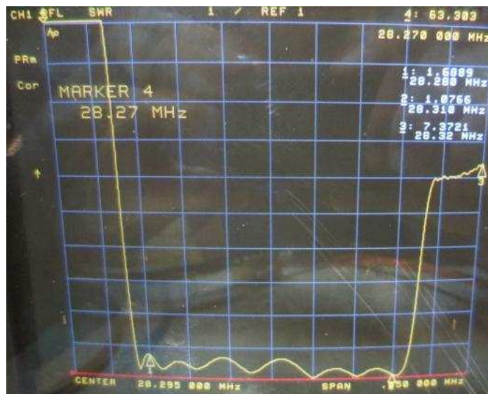
obr.č.18 Přizpůsobení při šířce pásma 50KHz
