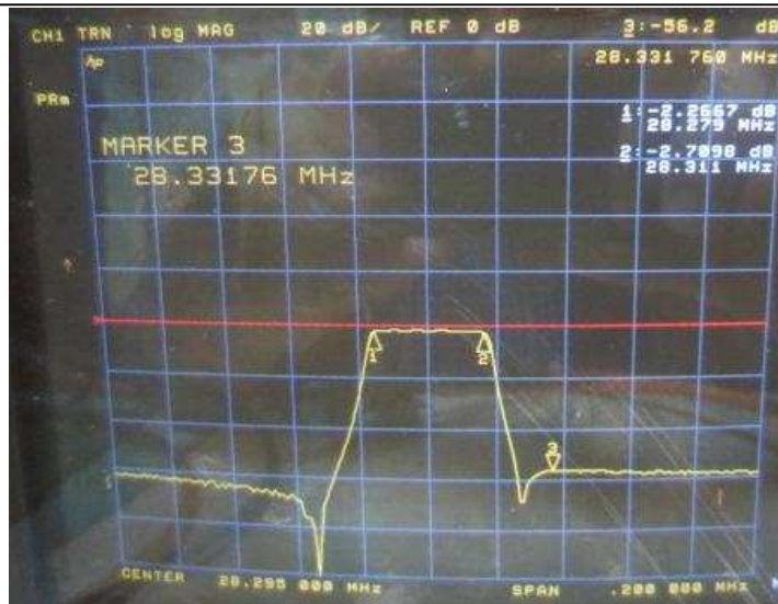
obr.č.14 Přenos při šířce pásma 200KHz a 20dB na dílek
