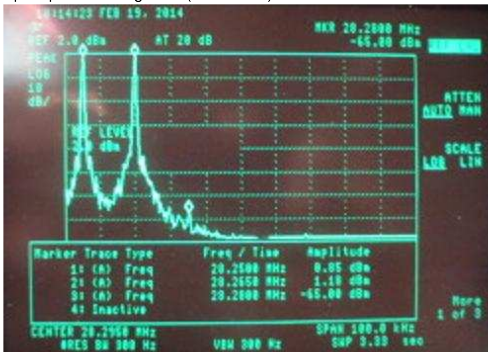
obr.č.2 Frekvenční spektrum na výstupu dvoutónového generátoru (0dBm, \Delta 15\text{KHz} )
