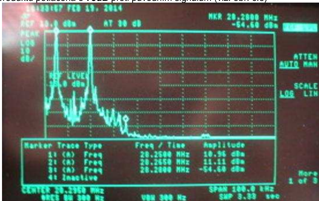
obr.č.5 Frekvenční spektrum na výstupu dvoutónového generátoru(+10dBm, \Delta 15\text{KHz} )
