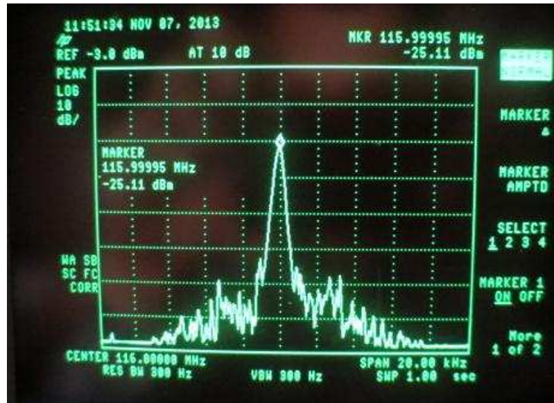
obr.č.3 Signál lokálního oscilátoru na výstupu transvertoru
